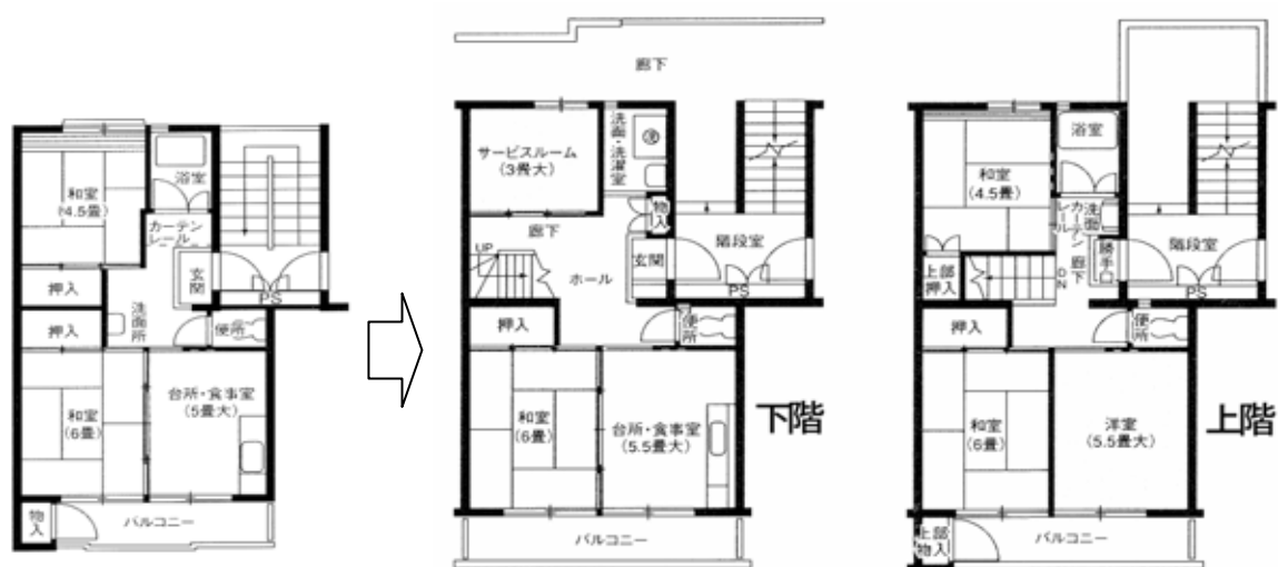
床スラブの一部を抜いて住宅内に階段をつかった 上下メゾネット型の2戸1戸化
